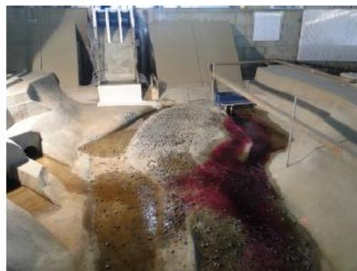
Figura 2.7.560 – Escoamento efluente da central principal, condição sem muro na margem direita do canal de fuga.
