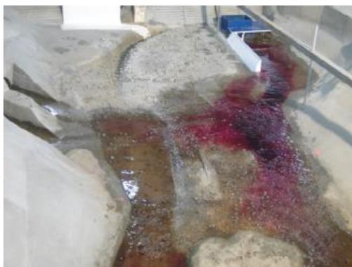
Figura 2.7.559 – Escoamento efluente da central principal, condição com muro na margem direita do canal de fuga.
