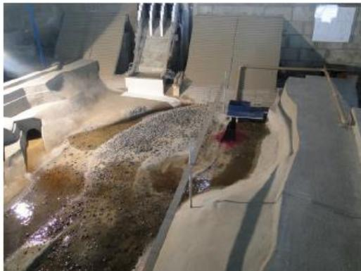
Figura 2.7.558 – Escoamento efluente da central principal, condição sem muro na margem direita do canal de fuga.
