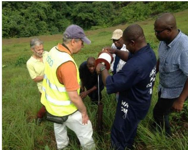
*Medição do nível piezométrico na Barragem de Guma (Serra Leoa, 2019)*
