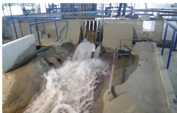
*Modelo geral do aproveitamento hidroelétrico de Laúca*
