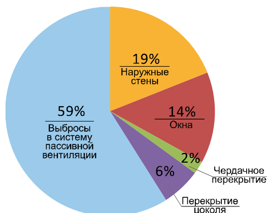
Рис. 11: Потери отпускаемой тепловой энергии в жилом типовом здании
