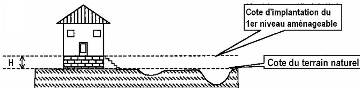
**Fig. 2. Définition de la hauteur d'implantation**
