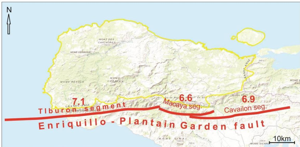
Figure 96 : Localisation de la Faille de la Presqu'île du Sud (nommée Faille « Enriquillo-Plantain Garden » dans cette carte) et magnitudes maximales des segments du système de faille
