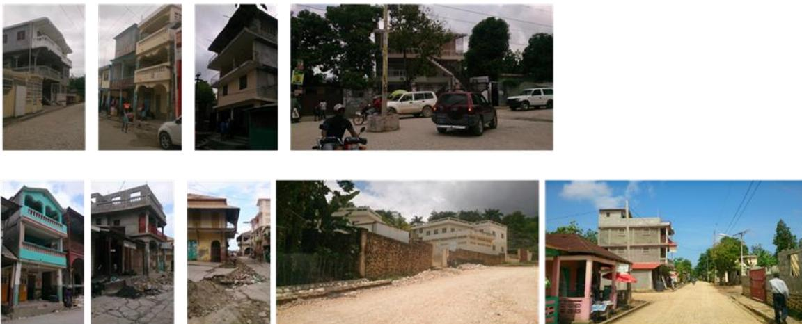
Figure 40 : Type 7 : Construction (R+2 – R+3) Béton + agglo + Toit Béton
