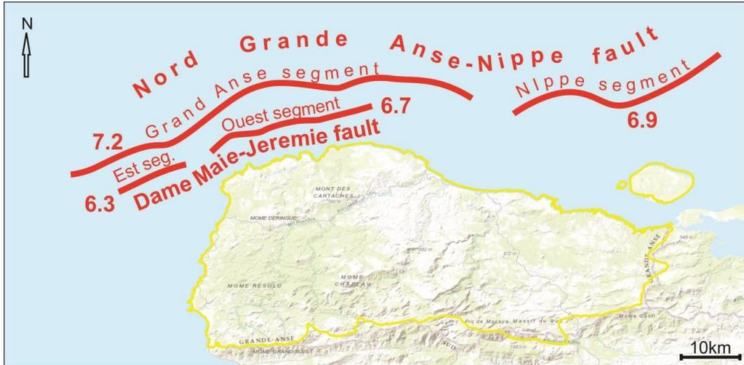
Figure 94 : Magnitude des segments du système de faille Nord Grand'Anse-Nippe
