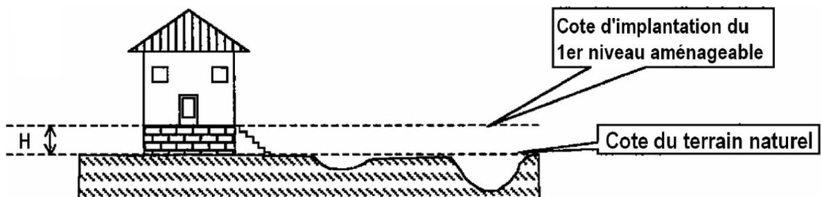
Figure 44 : Définition de la hauteur d'implantation
