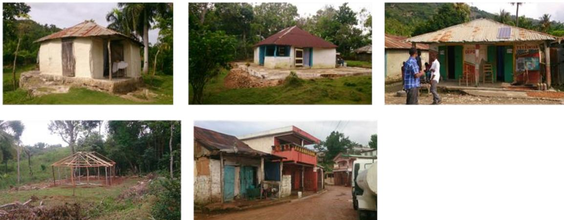
**Figure 34 : Type 1 : Habitat Traditionnel (RDC) – Ossature bois + toit tôle ou chanvre**
