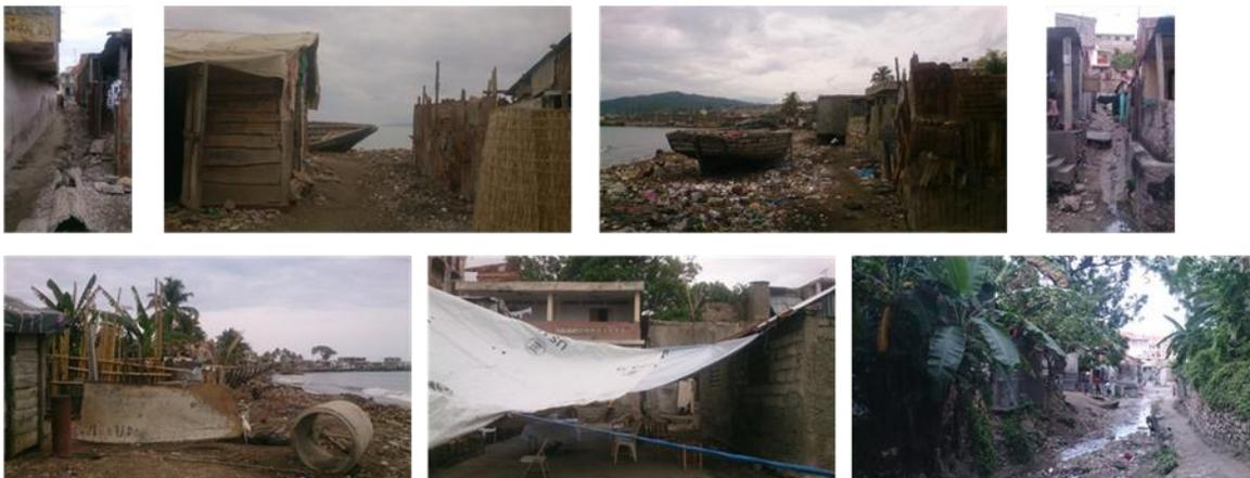
Figure 36 : Type 3 : Construction précaire (RDC - R+1) - bois - tôle - agglo + toit tôle
