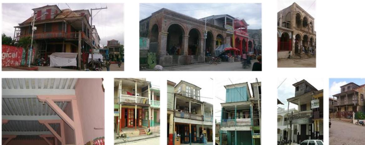
**Figure 35 : Type 2 : Construction patrimoniale (R+1, R+2,...) - Ossature bois et/ou brique + toit tôle**
