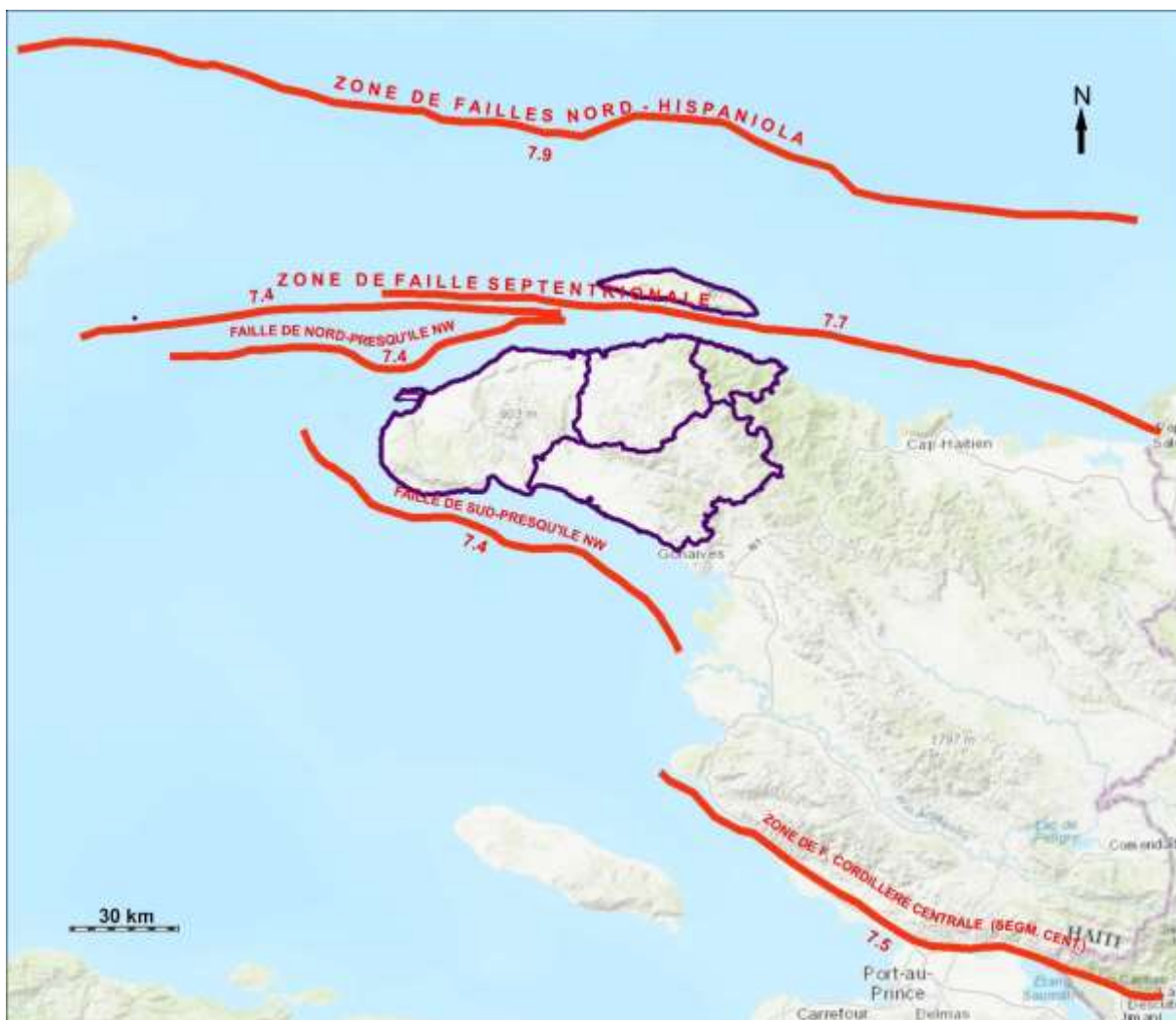
Figure 96 : Localisation des failles actives retenues pour l'évaluation de l'aléa sismique du département du Nord-Ouest et l'arrondissement de gros Morne du département limitrophe de l'Artibonite.
