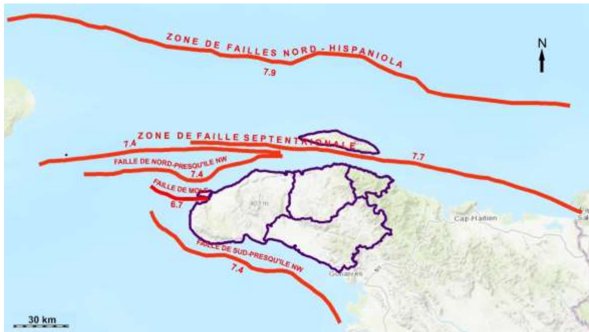
Figure 94 : Carte de synthèse des différentes failles actives « offshore » de la Presqu'île du Nord-Ouest et évaluation de la magnitude maximale selon Wells and Coppersmith (1994) et Coppersmith (1991).
